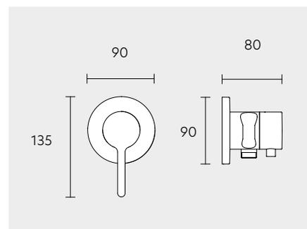
**Set de mitigeur mécanique encastré pour 2 voies avec prise d'eau et support douchette**
