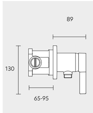
**Set mitigeur mécanique encastré avec prise d'eau**
