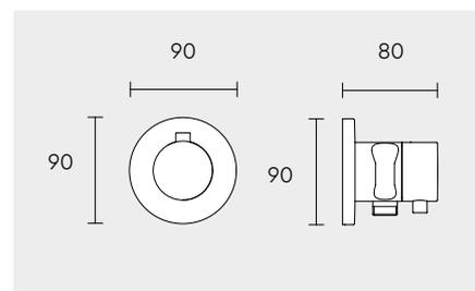
**Set de mitigeur thermostatique encastrée pour 3 voies avec prise d'eau et support douchette**
