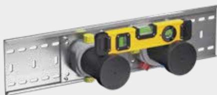
1. Les corps d'encastrement ont le même diamètre pour toutes les façades, ce qui permet de les ajuster avec un niveau à bulle. Les corps d'encastrement sont automatiquement alignés après avoir été accrochés au rail.
