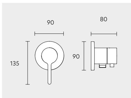
**Set de mitigeur mécanique encastré pour 2 voies avec prise d'eau**
