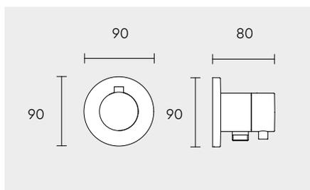
**Set de mitigeur thermostatique encastrée pour 2 voies avec prise d'eau**
