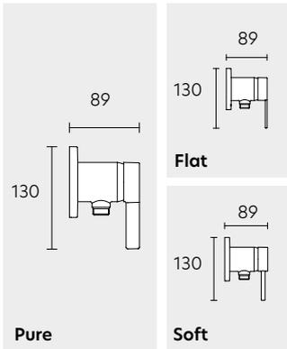
**Mitigeur mécanique encastré avec prise d'eau**
