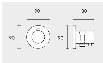
**Set de mitigeur thermostatique encastrée pour 2 voies avec prise d'eau et support douchette**
