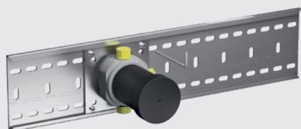
Функциональный блок можно точно настроить с помощью шпилек с резьбой, чтобы он находился под прямым углом относительно стены. При использовании монтажной планки резьбовые шпильки используются для фиксации модулей на планке.
