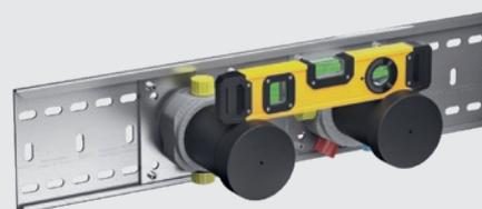
Die Baustopfen haben bei allen Modulen den gleichen Durchmesser, so dass sie zum Justieren mit der Wasserwaage genutzt werden können. Bei Verwendung der Montageschiene, wird die Schiene ausgerichtet. Die Funktionskörper sind nach dem Einhängen in die Schiene automatisch ausgerichtet.
