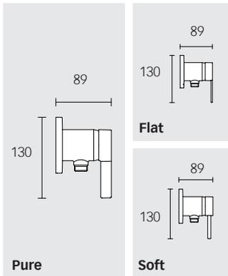
**Einhebel-Brausemischer Unterputz mit Schlauchanschluss**
