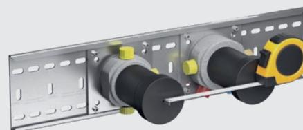
Die Baustopfen sind vorderseitig mit Passkreuzen versehen, mit deren Hilfe sich der Abstand zwischen den Modulen exakt messen lässt. Auf der Schiene können die Funktionskörper stufenlos verschoben werden.
