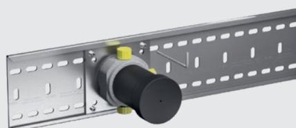
Mit den Gewindestiften lässt sich die Funktionseinheit so fein justieren, dass sie perfekt im rechten Winkel vor der Wand steht. Bei Verwendung der Montageschiene werden die Gewindestifte zur Fixierung der Module auf der Schiene verwendet.
