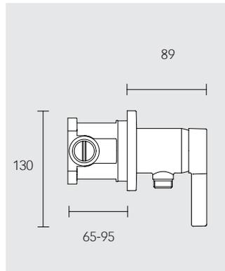
**Einhebel-Brausemischer Set Unterputz mit Schlauchanschluss**
