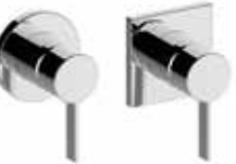
59551 Páková směšovací armatura podomítková DN 15 směšovací kartuše s keramickými těsnicími kroužky a teplotní zarážkou Součásti vrchní sady: páka, objímka, růžice (kulatá nebo hranatá) a funkční jednotka, vhodná pro podomítkovou funkční jednotku obj. číslo 59551/000070
